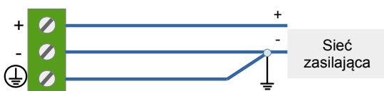
Rys. 4. Zasilanie napięciem stałym z uziemionym biegunem ujemnym
